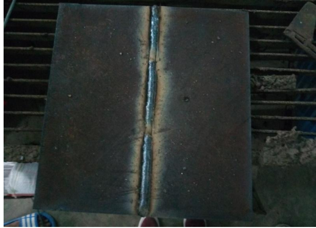
Gambar 5. Hasil Pengelasan SMAW
