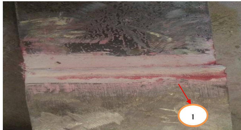
Gambar 2. terdapat cacat pada permukaan pada posisi Horizontal yaitu undercut (1)
