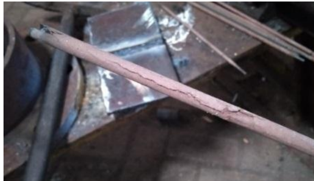
Gambar 3. Kondisi elektroda basah setelah digunakan
