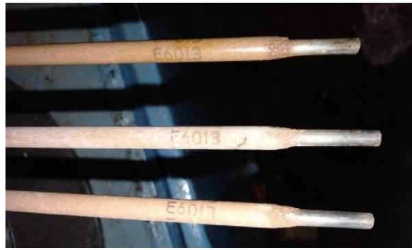
Gambar 2. Elektroda E6013 dengan Kondisi Basah, kondisi lembab dan kondisi baru
