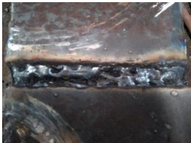
Gambar 4. Hasil pengelasan menggunakan elektroda basah
