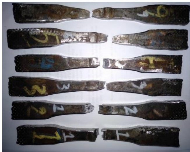
Gambar 6. Plat A36 setelah uji tarik
