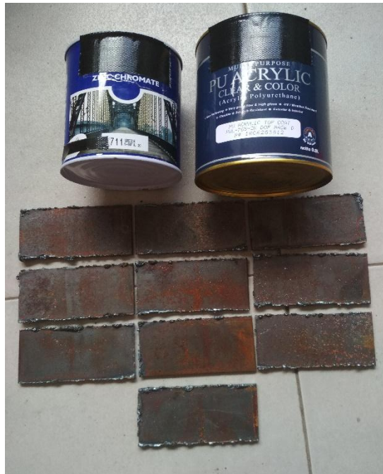
Gambar 1. Spesimen berdimensi 10 cm x 5 cm dan cat Zinc Chromate dan cat Urethane
