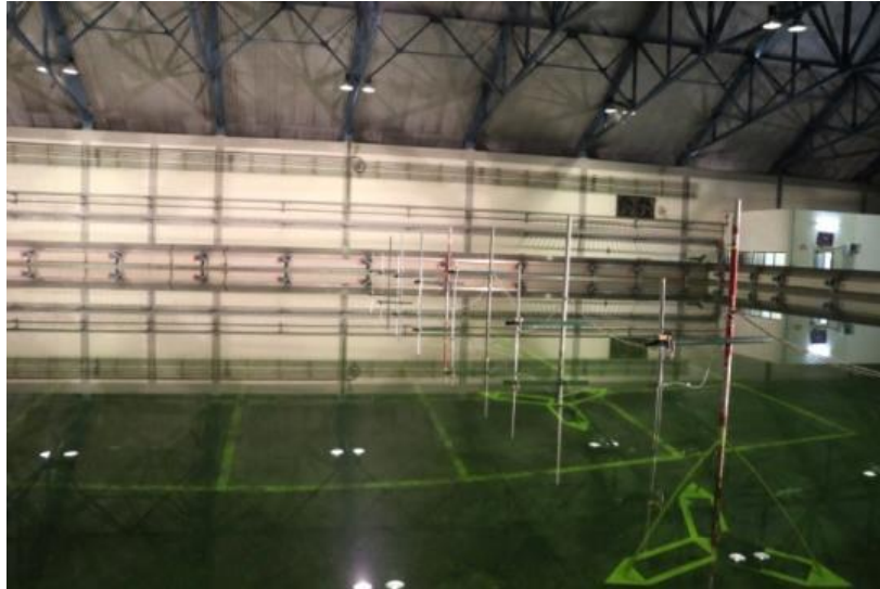
Gambar 5. Setup Wave Probe di Kolam Uji
